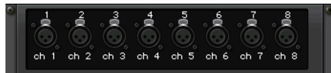
Si pulsa la tecla [SEL] de un canal de entrada, se iluminará el puerto correspondiente. (No se ilumina para las consolas serie CL).
