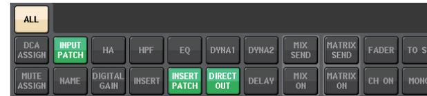
Esta figura indica que los parámetros INPUT PATCH, INSERT PATCH y DIRECT OUT se han establecido en Safe mediante los ajustes de parámetros globales de INPUT PATCH. Del mismo modo, al activar los parámetros globales INPUT NAME, OUTPUT PATCH y OUTPUT NAME provocarán que los parámetros seguros correspondientes de cada canal se iluminen en verde. Los botones en pantalla y los parámetros correspondientes se aplican a los siguientes canales:
