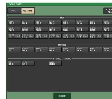
Aquí puede especificar los canales que se excluirán de las operaciones de Solo. (Puede especificar más de una opción). Los canales aquí seleccionados no se silenciarán cuando esté activado el modo SOLO. Esta función es útil si, por ejemplo, se desea proteger ciertos canales de que se ajusten accidentalmente en modo SOLO, por ejemplo los canales STEREO principales y los canales MIX que envíen señales a un grabador externo.
