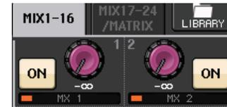
El mando TO MIX SEND LEVEL aparece del mismo color que el mando correspondiente en la sección SELECTED CHANNEL. En este caso, puede utilizar el mando correspondiente de la sección SELECTED CHANNEL para ajustar el nivel de envío.
