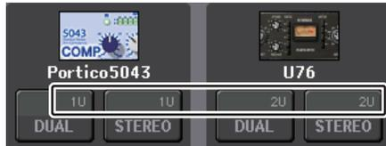
La U76 ocupa dos espacios de bastidor. Los demás procesadores ocupan un espacio en bastidor. Si monta un procesador Premium Rack de dos espacios en el bastidor, no podrá montar ningún otro procesador debajo de estos espacios de bastidor. Además, no puede montar un procesador sobre dos espacios en un bastidor par.
