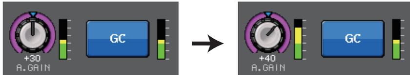
En este momento, la ganancia de cada entrada de señal a la consola serie CL se ajustará mediante el parámetro de ganancia digital de la consola serie CL.
