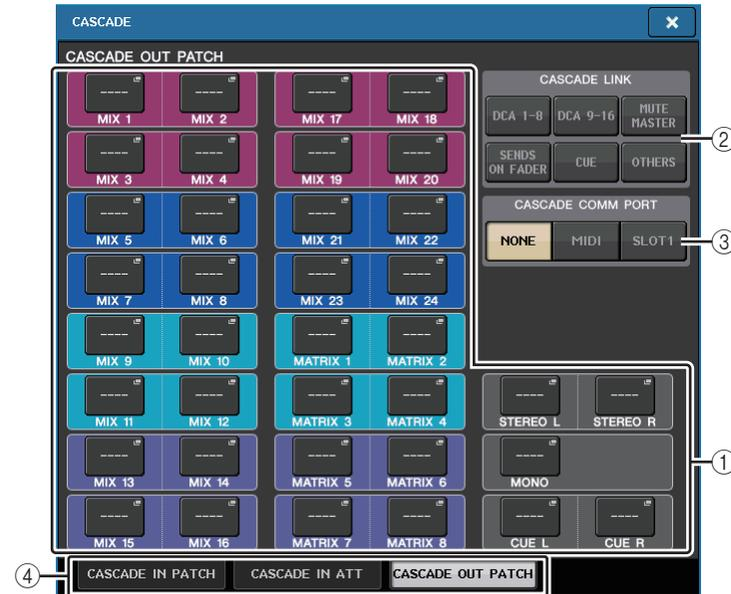
**① Botones OUT PATCH (sección CASCADE OUT PATCH)**
