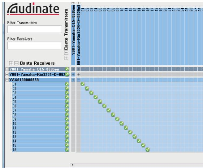
En este caso, deberá cambiar los ajustes de DANTE INPUT PATCH de la consola serie CL en función de si va a realizar grabación o reproducción de varias pistas. Si ha guardado estos conjuntos de ajustes diferentes en DANTE INPUT PATCH LIBRARY ([página 168](#)), resultará fácil cambiar entre ellos.
