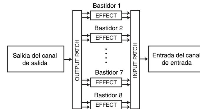
También puede asignar la entrada y salida del efecto interno a la entrada/salida inserción del canal deseado (salvo un canal ST IN), para que el efecto se inserte en ese canal.
