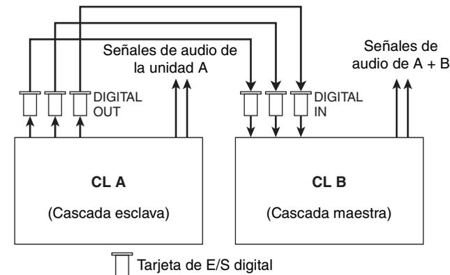
En este ejemplo, pueden compartirse hasta veinticuatro buses elegidos desde los buses MIX 1-24, los buses MATRIX 1-8, el bus STEREO (L/R), el bus MONO (C) y el bus CUE (L/R), y las señales mezcladas transmitidas desde la unidad CL de cascada maestra. (Si utiliza tres tarjetas de E/S digital de 16 canales, los dispositivos pueden compartir todos los buses).
